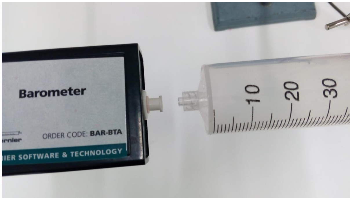
Obrázek 6. Připojení injekční stříkačky k tlakoměru Vernier
