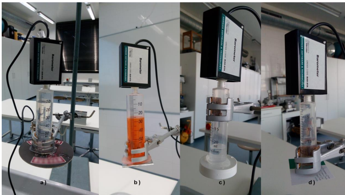
Obrázek 2. Různé typy destiček: a) impregnovaný tuhý papír, b) tuhý papír obalený hliníkovou fólií, c) plastové víčko d) list papíru.
