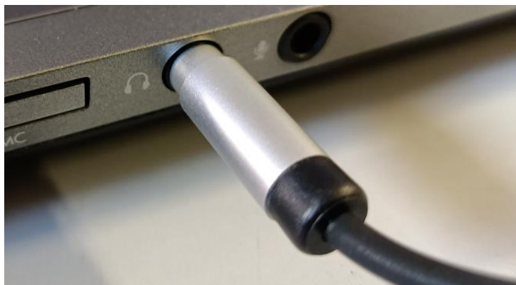
Obr. 2 Detail připojení konektoru 3,5 mm jack.
