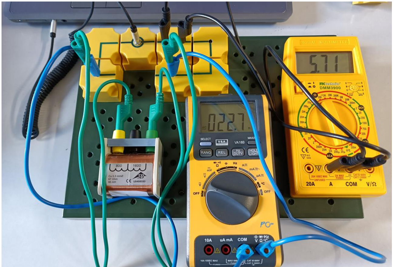
Obr. 4 Základní sestava elektrického obvodu s cívkou.
