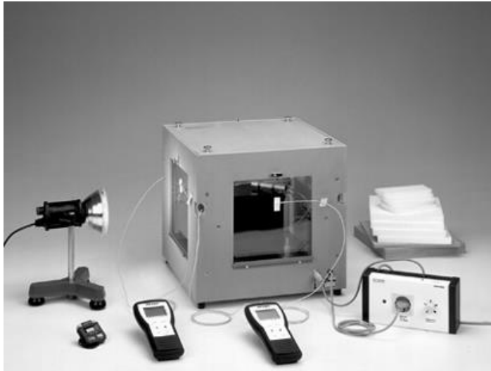
Obr. 2 : Sestava pomůcek k měření součinitele prostupu tepla k
