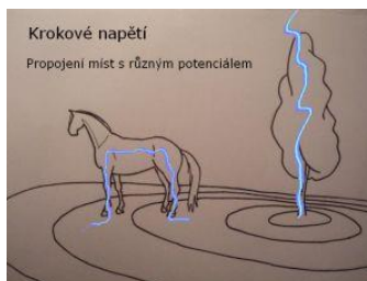
blesku na zem. Elektrony z blesku putují po zemském povrchu a takové povrchové zemní proudy jsou smrtné. Na obr. 24.14 jsou patrné zřetelné stopy těchto proudů.
