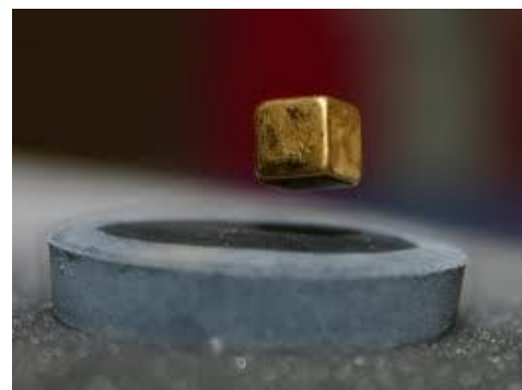
levitace magnetické kostičky nad supravodičem
