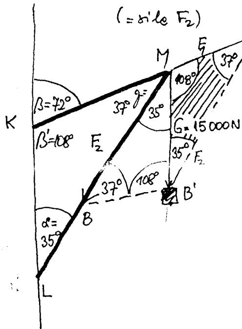
Rешение:  $\beta' = 180^\circ - 72^\circ = 108^\circ, \gamma = 180^\circ - (108^\circ + 35^\circ) = 37^\circ$
