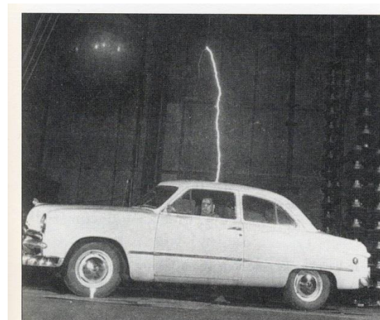
Obr. 25.20 Do karosérie auta udeřila mohutná elektrická jiskra a pak přeskočila přes izolující levou přední pneumatiku do země (všimněme si záblesku v tomto místě), aniž zranila osobu uvnitř auta.
