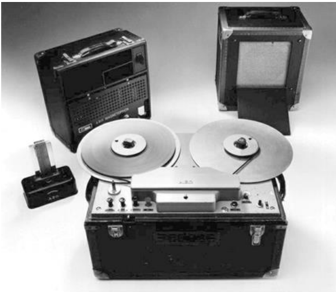
První magnetofon K1 z roku 1935, používající k magnetickému záznamu tenký acetylcelulóзовý pásek
