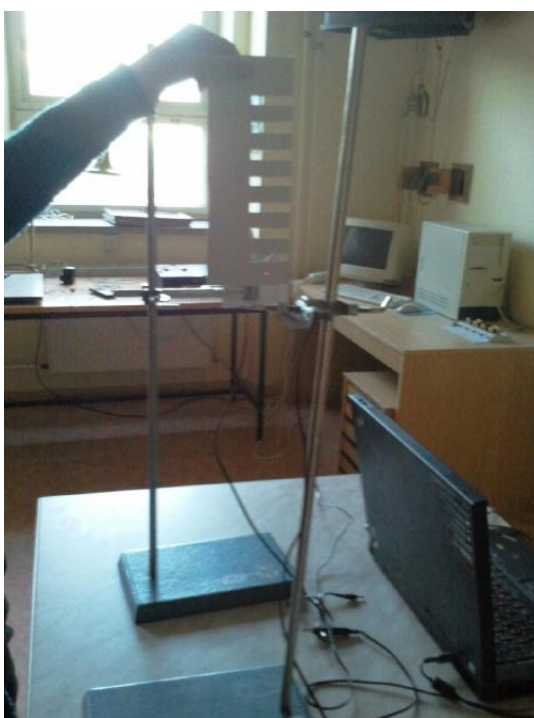
Obr. 4 Uspořádání experimentu – volný pád hřebene
