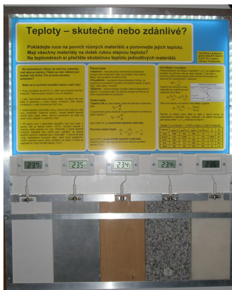
Obr. 4 Interaktivní nástěnka demonstraci dotykové teploty na různých druzích materiálů – dole zleva panely materiálů: plast (Trovitex), kov (hliník), dřevo, žula, plast (Silon).
