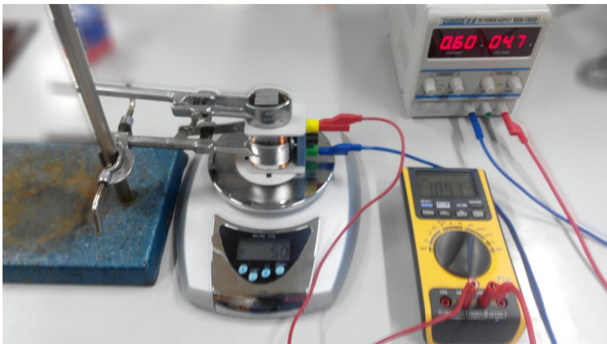
Obrázek 3.1.1 Uspořádání experimentu – Měření magnetické indukce elektromagnetu
