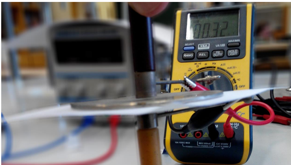
Obrázek 3.2.1 Uspořádání experimentu – Měření permitivity a permeability vakua
